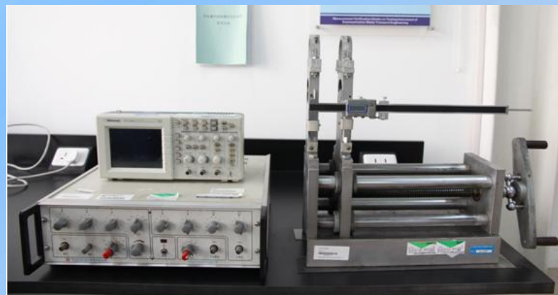
平面换能器检定装置
