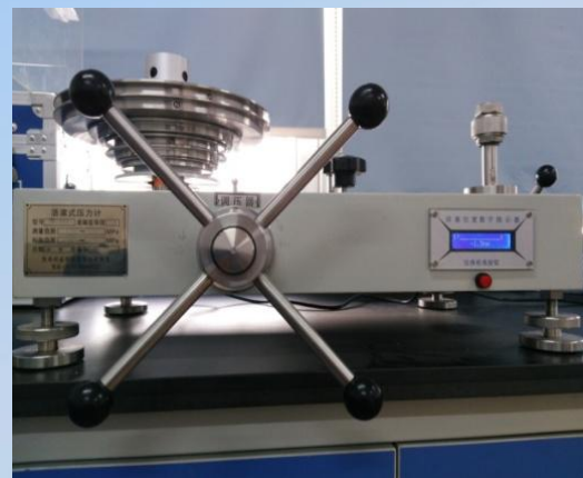
桩基静载仪检定装置
